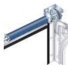
Torsion avant avec sécurité par-chute
