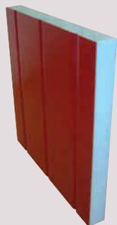
Il est constitué d'une âme isolante en Polystyrène Extrudé Haute densité et un parement réalisé par deux robustes tôles aluminium profilées, \*l'épaisseur totale du panneau est de 28 mm et bénéficie d'une **garantie de 10 ans**.
